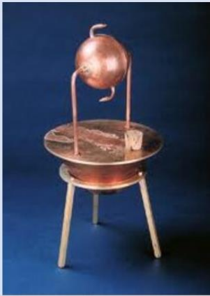
Turbine à vapeur romaine, inventée par Héron d'Alexandrie. Pour les Romains, ce n'était qu'un jouet.
